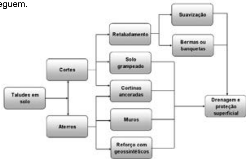
Figura 9.2: Métodos de estabilização em solos (Geo-Rio, 2000).
