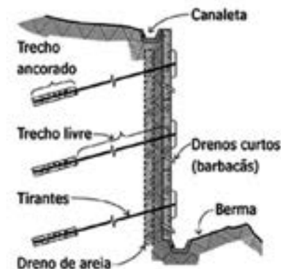
Figura 9.7: Conteção com uso de tirante (Revista Techene, 2007)
