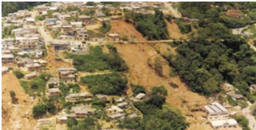
FIGURA 1 – EXEMPLO DE ENCOSTA FRAGILIZADA PELA OCUPAÇÃO PRECÁRIA. PETRÓPOLIS/RJ, DEZEMBRO DE 2002 (FONTE: SECRETARIA DE OBRAS DA PREFEITURA MUNICIPAL DE PETRÓPOLIS).
