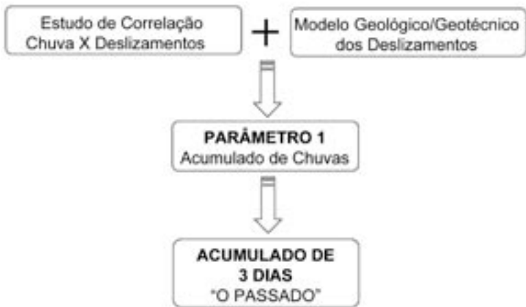
FIGURA 5. FLUXOGRAMA CONTENDO A FORMA DE OBTENÇÃO DO 1º PARÂMETRO DO CRITÉRIO TÉCNICO.
